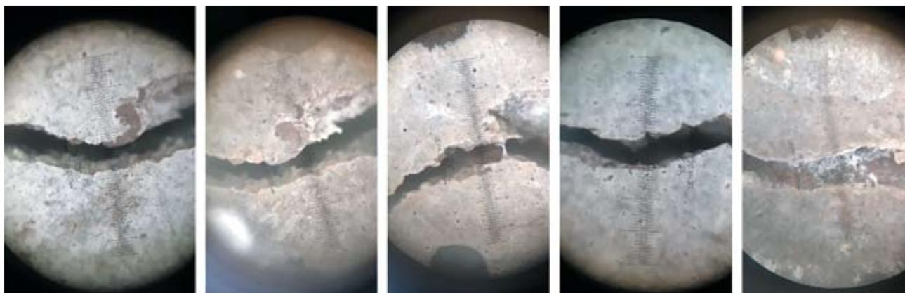
Рис. 4. Примеры зарастания трещин
