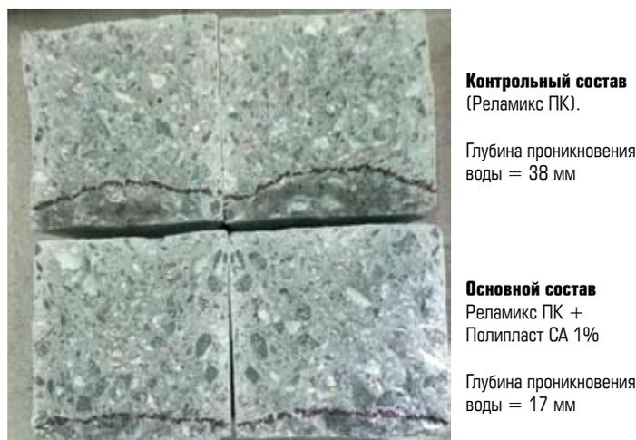
Рис. 2. Проницаемость бетона без (сверху) и с (снизу) добавкой Полипласт СА
