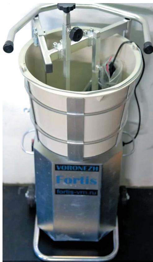
Рис. 1. Используемый лабораторный бетономеситель принудительного действия, производимый компанией Fortis
