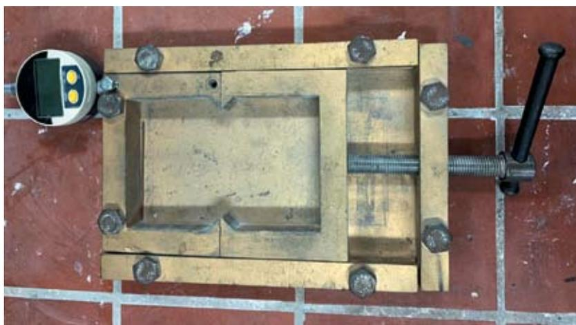
6. Испытания трещиностойкости покрытий на бетоне по ГОСТ 31383
