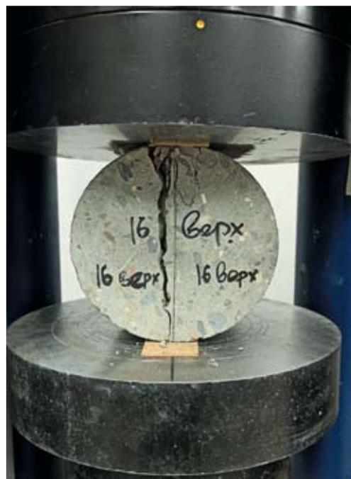
2. Фото образцов бетона при испытаниях на растяжение при раскалывании
