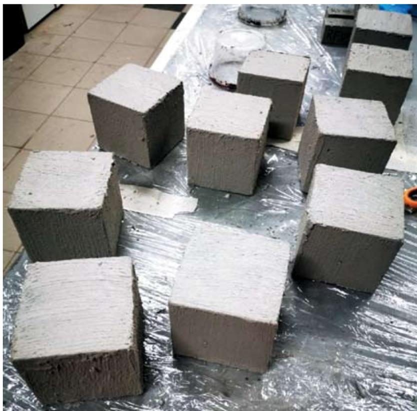
4. Фото образцов с нанесенным защитным покрытием на бетоне
