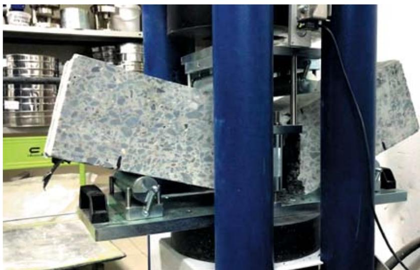
3. Фото образцов бетона при испытаниях на растяжение при изгибе
