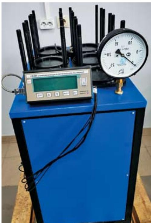
5. Фото установки для испытаний бетона и защитных покрытий для бетона на водонепроницаемость методом «мокрое пятно»
