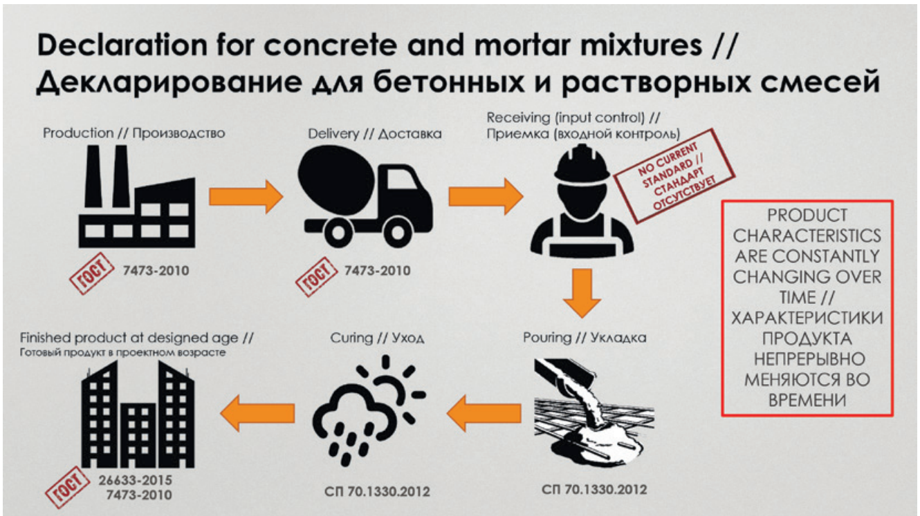
Fig. 2. Process of handling finished concrete and mortar mixtures on the market Рис. 2. Процесс обращения готовых бетонных и растворных смесей на рынке
